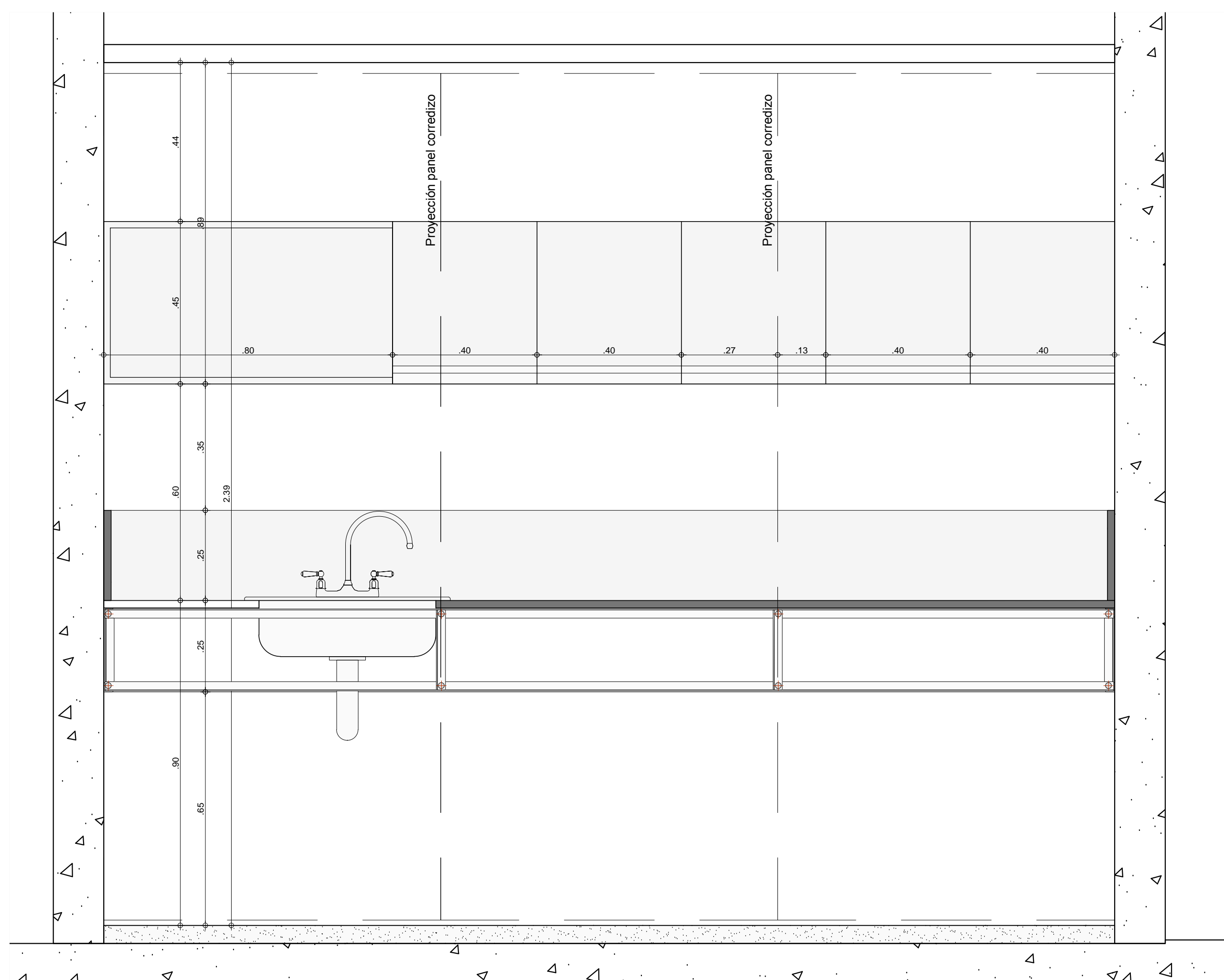
MUEBLE FIJO TIPO 01B - CORTE B ESCALA 1:10
